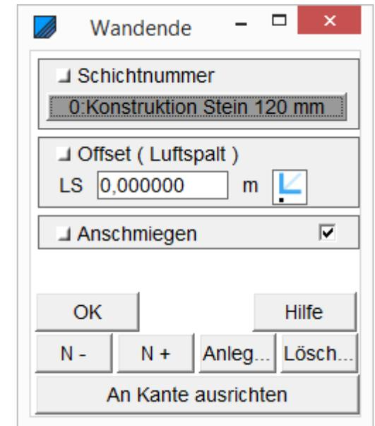
In diesem Beispiel sollte Anschmiegen angehakt sein und das **KOPFENDE** der Wand sollte nochmals über den Button **AN** der hier senkrechten Wand **KANTE** der anderen Wand **AUSGERICHTET** werden.
